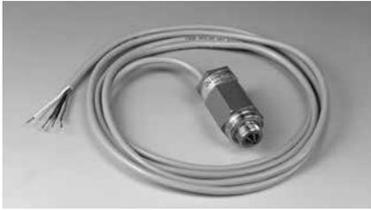
Sensore di rilevamento della presenza dell'acqua basato sul principio opto-elettronico, quindi non invasivo e senza parti in movimento. Il sensore fornisce un contatto elettronico (on/off) da utilizzare per fermare l'elettropompa in caso di mancanza acqua nella zona della tenuta meccanica.
