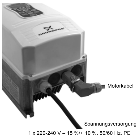
Abb. 12 Anschlüsse am Frequenzumrichter
