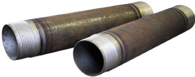
La nostra gamma di Tubi di Rivestimento viene realizzata attraverso la saldatura dei manicotti in acciaio 42CrM04 ad un tubo intermedio in materiale N80. I manicotti inoltre, sono sottoposti ad un processo di nitrurazione, al fine di garantirne un'ancora maggiore resistenza all'usura del filetto. La certificata qualità degli acciai utilizzati, abbinata all'efficiente processo produttivo, ci permette di offrire ai nostri clienti le migliori prestazioni di prodotto presenti sul mercato.
