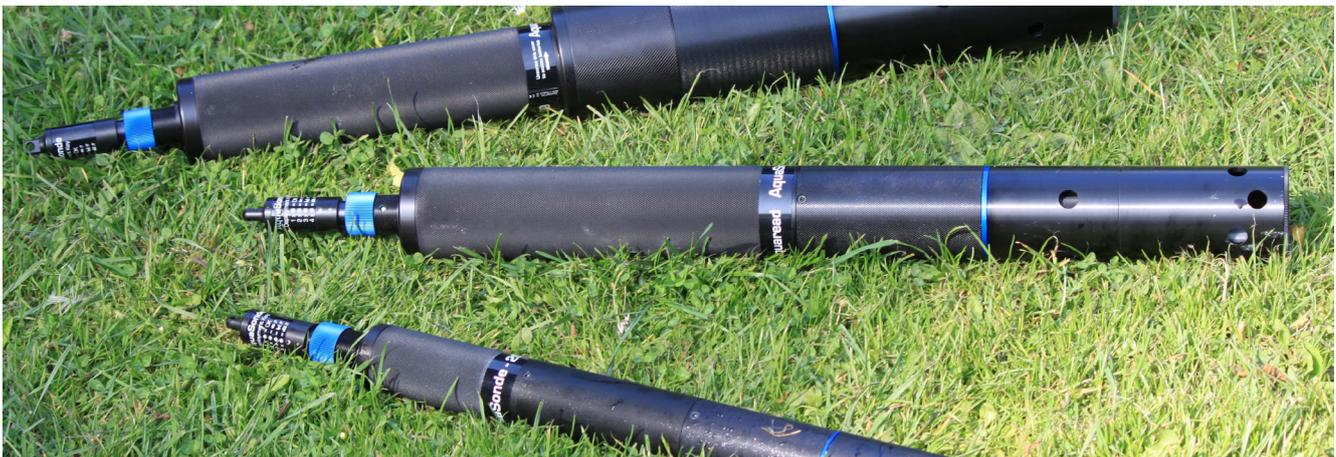
La nuova gamma Aquasonde estende le potenzialità delle sonde Aquaread aggiungendo la memoria e la batteria interna, permettendo quindi l'installazione fissa della sonda.
