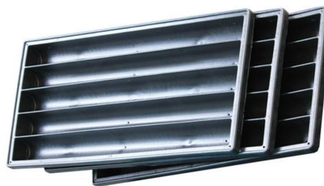
Realizzate in polietilene, sono adatte a contenere fino a 5 carotaggi Ø 101 mm e lunghezza 1 mt. Dotate di separatore di strati in PVC.
