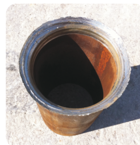
Tubo di rivestimento tagliato mediante tagliatubi Casing tube cutted with the casing cutter.
