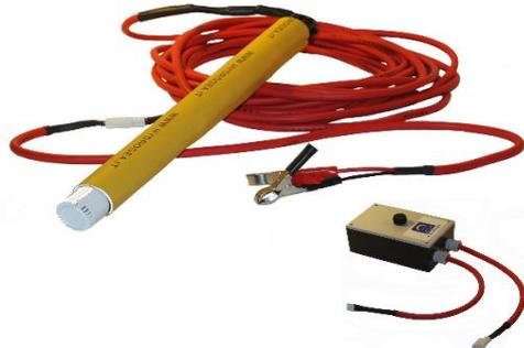
La Pompa 12 V a 3 stadi per il campionamento di acque di falda con prevalenza 18 Mt viene fornita di serie con 18 metri di cavo elettrico, corredato con connettori terminali a due vie maschio/femmina ad innesto rapido. La Pompa inoltre è dotata di filtro in aspirazione intercambiabile. Il Regolatore Di Flusso, non viene fornito all'acquisto della pompa. Viene venduto come Accessorio.
